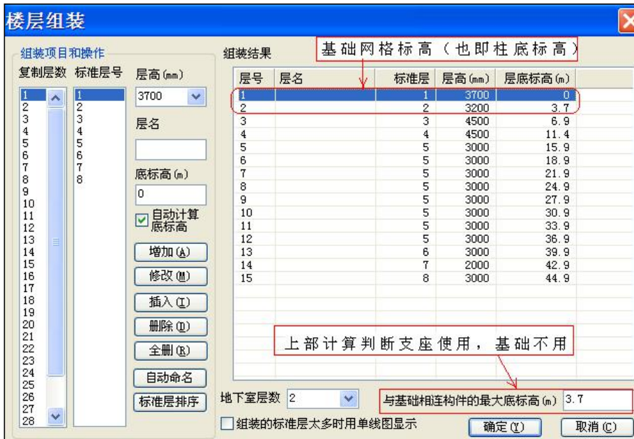
楼层组装与基础标高的关系
